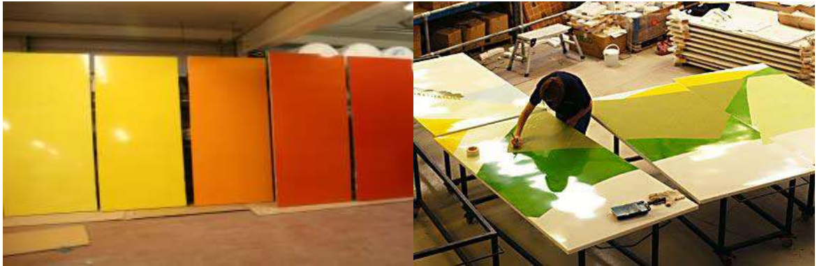
شكل (٣) صور توضح تطبيق المينا على بلاطات الصاج وفقا للتصميم والألوان المطلوبة
