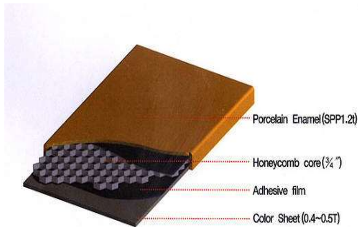
شكل (٦) صور توضح طبقات المينا الحرارية المطبقة على بلاطات الصاج
