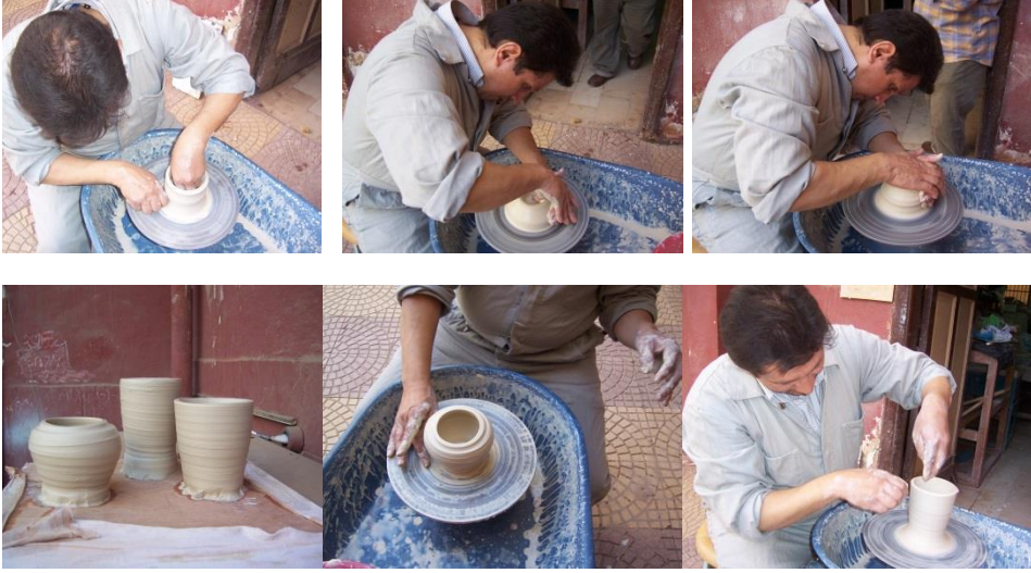
شكل ( ٣ ) توضح الصور إمكانية تشكيل الطينة على الدولاب
