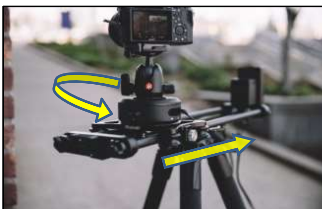
شكل (١٢) حامل منزلق يسمح بدوران الكاميرا حول محورها أثناء حركتها الأفقية
