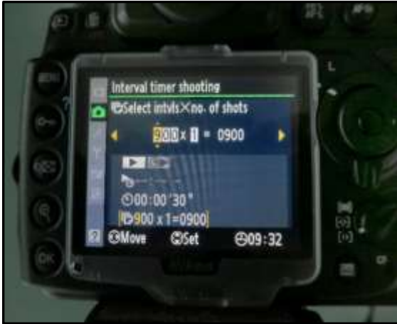
شكل (٣) كاميرا نيكون مزودة بخاصية تحديد الفترة الفاصلة مدمجة بداخلها
