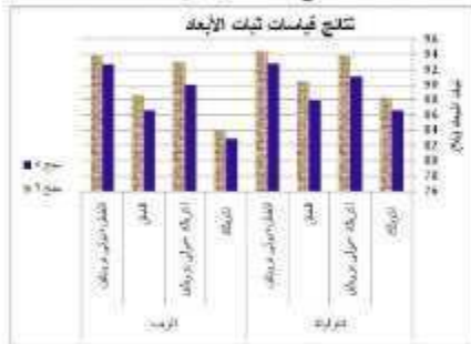
شكل (١٠) نتائج قياسات ثبات الأبعاد للخامات المتنوعة مع تغير الترتيب البنائي والبيج
