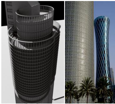
الصورة (١٠) توضح الاختلاف بين البرج الاسطواني المصمت وذو الفتحات
