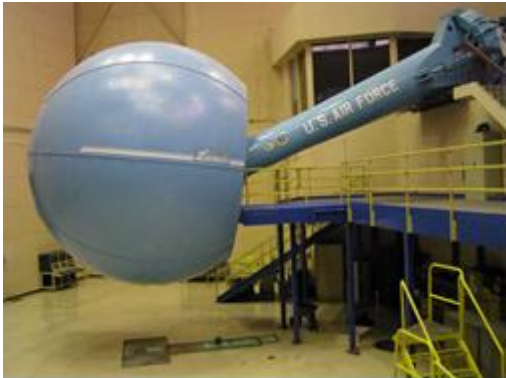
(شكل ١٩) نظام محاكاة الطيران لرواد الفضاء
