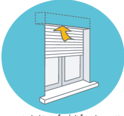
شكل ( ٧ ) تتم الحركة الرأسية بوسائل التحكم عن بعد في تدوير الستارة بواسطة المحرك للأعلى داخل صندوق خاص.
