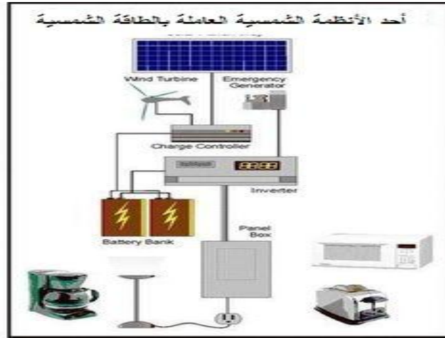
شكل (٣) نظام شمسي هوائى يعتمد بالأساس على الشمس فى توليد الطاقة الكهربائية فى تشغيل الأجهزة. (٧)
