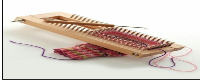
صورة رقم (٤) توضح نول التريكو الخشب القابل للتعديل أو نول الجورب
