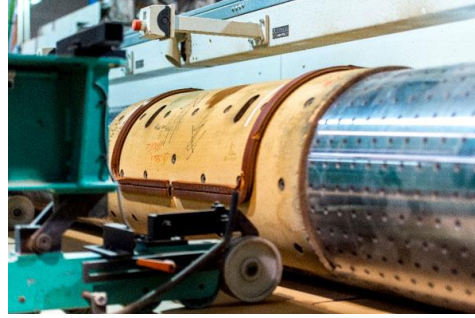
صوره (١٣) توضح شكل قوالب الطباعة المحملة على بكرات لقطع الألواح الليفيه المموجة وطباعتها وطبيها. (technical information, 1952 - 2021)
