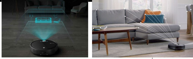
شكل (١٦/أ،ب) وظيفة الكاميرا المجهزة بالمكنسة الروبوتية
