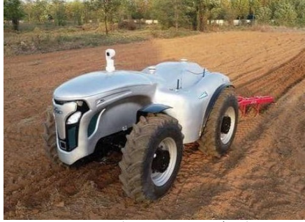
شكل (١١) النموذج الأولي لجرار كهربائي ذاتي القيادة يسمى إي تي ١٠٠٤ دبليو
