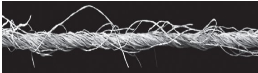
شكل (٦ - أ) خيوط الفسكوز المجهزة ب PCM مصنوعة من الياف صناعية دون تشعيرو شكل (٦ - ب) خيوط البامبو مصنوعة من ألياف بها تشعير
