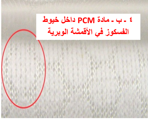
شكل (٤-أ) الأقمشة الوبرية الذكية المجهزة بخامة PCM و شكل (٤-ب) مادة PCM داخل خيوط الفسكوز في الأقمشة الوبرية (١٧)
