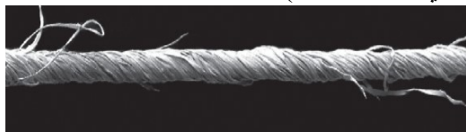
شكل (٦ - أ) خيوط الفسكوز المجهزة ب PCM مصنوعة من الياف صناعية دون تشعيرو شكل (٦ - ب) خيوط البامبو مصنوعة من ألياف بها تشعير
