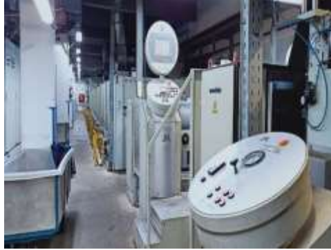
(صوره ٢٠) جهاز الرام للتجفيف والتنشيط الحراري للقماش
