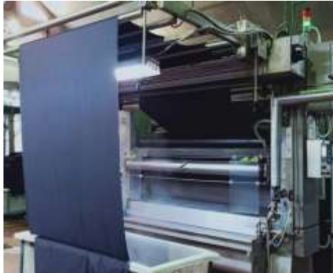
(صوره ٢١) جهاز الفولار لمعالجة لون القماش
