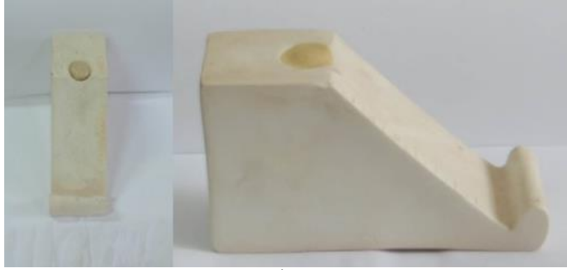
شكل (٤) صورة توضح شكل المخروط الذي يطبق عليه الطلاء الزجاجي لاختباره
