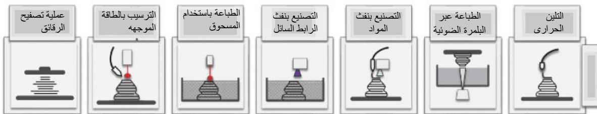
الشكل (٢): تصور طرق الطباعة ثلاثية الأبعاد المختلفة.
