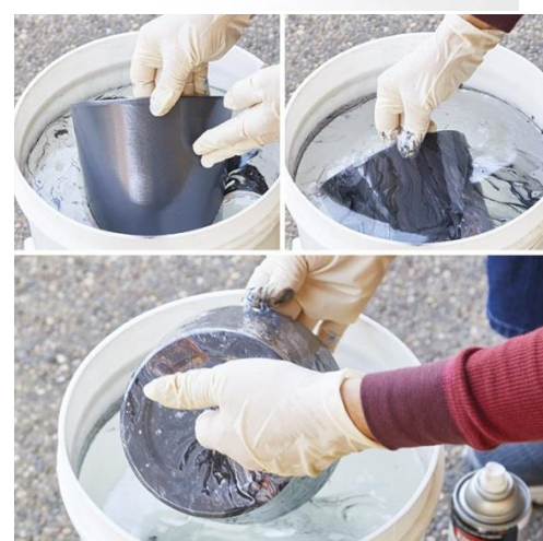
شكل (١٩) صور عملية السحب اللوني والادوات المستخدمة وكيفية اتمام عملية السحب على الاسطح
