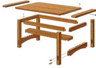
صورة رقم (١٨) توضح الربط بين أجزاء المنضدة بالطريقة المعتادة المعتمدة على التعشيقات والغراء
