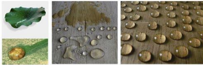
شكل رقم (١) يوضح العزل المائي و تأثير اللوتس على الأسطح الخشبية المعالجة بطبقات نانوية تعتمد على جزيئات السيليكا النانوية. في الصورة المركزية، من الممكن ملاحظة الفرق بين الخشب غير المعالج (أعلى) والخشب المعالج بطلاء نانوي (أسفل).
