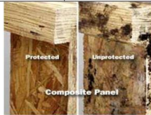
صورة رقم (٤١) يوضح اختبار المتانة الذي يتم إجراؤه على الأنواع الخشبية المركبة المحمية بطلاء الفضة النانوية وغير المحمية
