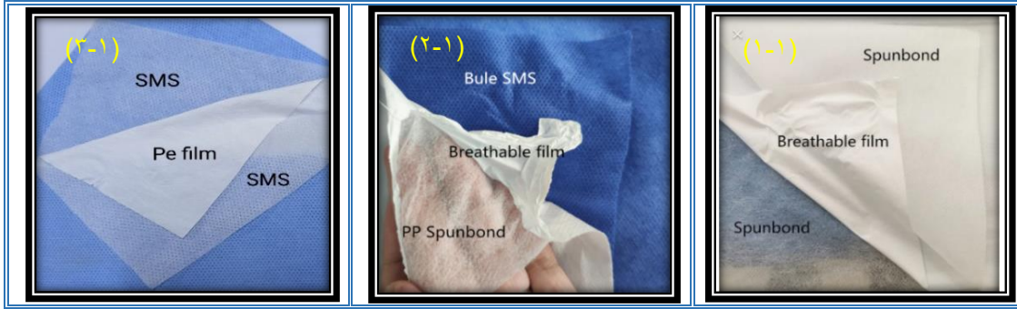
صورة (١) الأقمشة غير المنسوجة المركبة : (١-١) (SB PP/Microporous PE film/SB PP) و (٢-١) (SMS PP/Microporous PE film/SB PP) . (٣-١) (SMS PP/Microporous PE film/SB PP)
