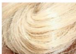
شكل (٢) يوضح الاستخراج الميكانيكي لألياف الموز (٢٤)
