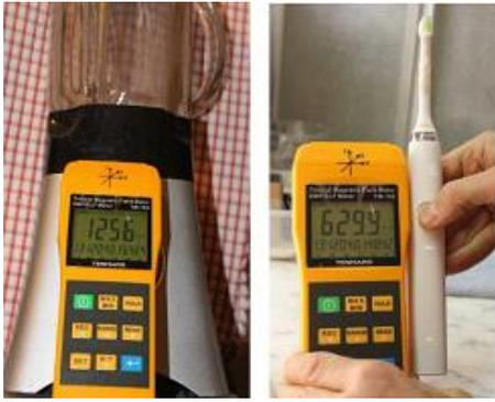
صورة (٨):قراءات جهاز LF Meter ثلاثي الأبعاد أثناء قياس الإشعاع الكهرومغناطيسي المنبعث عن فرشاة كهربائية و خلط أثناء تشغيلهم (٢٥:ص٣٧، ٤٣)
