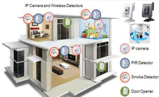
صورة رقم (١): توضح نظام المراقبة الأمني لأحد المباني السكنية، والذي يتكون من عدة مصادر للتلوث الكهرومغناطيسي، مثل كاميرا مراقبة "IP Camera"، وكاشف الأشعة تحت الحمراء "PIR Detector"، وكاشف الدخان "Smoke Detector"، ومتحكم فتح وغلق الأبواب "Door Detector"<sup>(٦٤)</sup>، وجميعها مرتبطة بلوحة تحكم رئيسية ومتصلة بالإنترنت، حيث ينتج عن كل عنصر من هذا النظام الأمني مجالات عالية التردد من الأشعة الكهرومغناطيسية المختلفة، والتي تمثل خطر على مستخدمي الفراغ.
