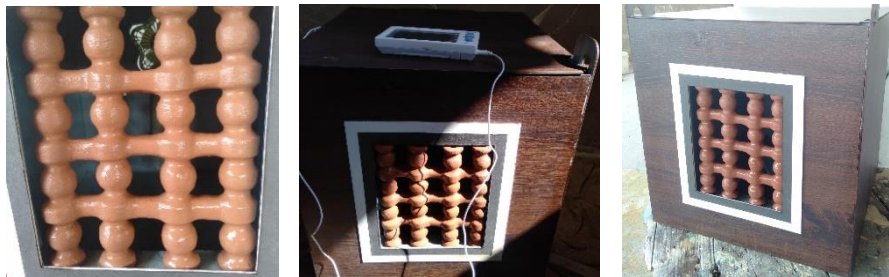
صورة ١٥ (أ-ب-ج): النموذج المصغر المنفذ للاختبار، مصنوع من الخشب المعزول حرارياً.
