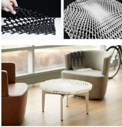
صورة رقم ( 10 ) مراحل طباعة السائلة السريعة Rapid liquid printing لمنتج داخل سائل هلامي المصدر https://selfassemblylab.mit.edu/rapid-liquid-printing صورة رقم ( 11 ) متضدة بإسبل ستون Basil stone والذي تم طباعة سطحها بواسطة RLP في تعاون بين معهد ماساتشوستس للتكنولوجيا مع شركة Steelcase المصدر https://selfassemblylab.mit.edu/rapid-liquid-
