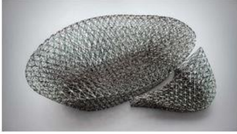
صورة رقم (5) أريكة sofa so good من تصميم Janne Kytanen's تم طباعتها بواسطة الطباعة الحجرية SLA وتتكون من 6000 طبقة وسمك الطبقة 0.0099 سم ، المصدر /https://cutt.us/IEjr4
