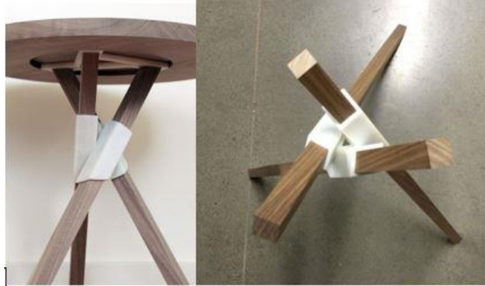
صورة رقم (8) استخدام وصلات مطبوعة كبديل لوصلات التجميع التقليدية وكجزء من مكمات التصميم المصدر https://www.woodworkingnetwork.com/community/project-gallery/walnut-table-prototype-using-3d-printing
