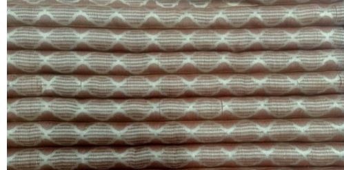
شكل (٧) قماش الحشو الخارجي بعد إضافة الميكروفيبر في الأماكن المنفصلة بالقماش
