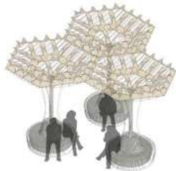
شكل (٤) تصميم تخيلي لسقف مظلة سريع الاستجابة لسقوط الأمطار بالفتح والغلق لتجميع المياه عن طريق نظام الأتمتة والمستشعرات. (٣٨)
